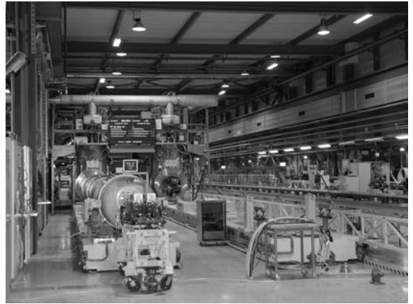
Fot. 2. Elektromagnes w hali, gdzie poddawany jest bardzo dokładnym badaniom jakościowym
