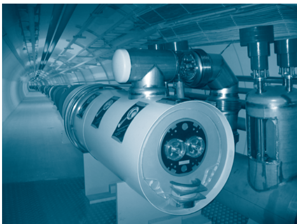
Fot. 1. Pierścień LHC w przekroju. Widoczne są otwory kanałów, przez które poruszać się będą wiązki protonów – w przeciwnych kierunkach
